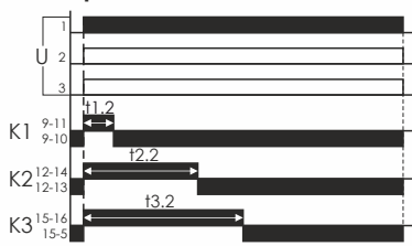
Режим F5. «Задержка выключения по K1...K3»
